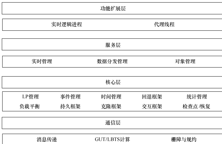
图5 “智能仿真引擎”的层次结构
